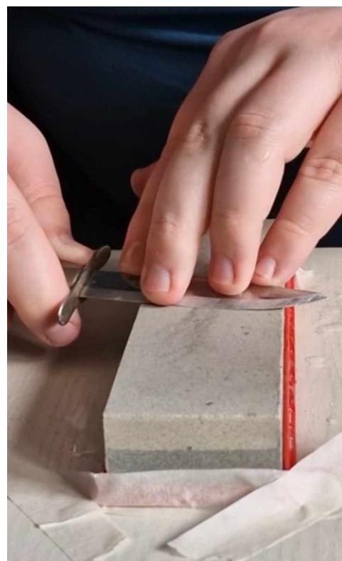
Figur 1 Første sliping på brynestein
