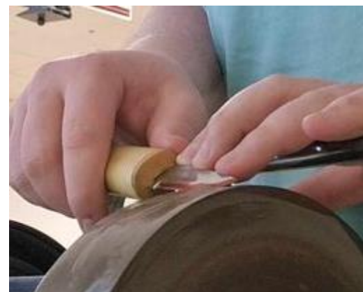
Figur 11 Sliping etter bruk av slipejigg
