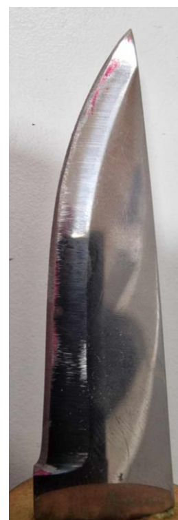
Figur 8 Resultat etter bruk av slipejigg
