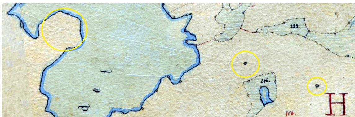
Figur 48. Trigonometriske punkter er markert i kartet, her ser man også tydelige spor fra arbeidet. Legg merke til «H» (stor litra indikerer situasjon etter utskifting).
