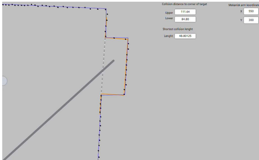
Figur 21 - Utklipp fra HMI-skjermen som viser at armen er plassert ut ifra X- og Y-koordinater som er plassert øverst i høyre hjørne
