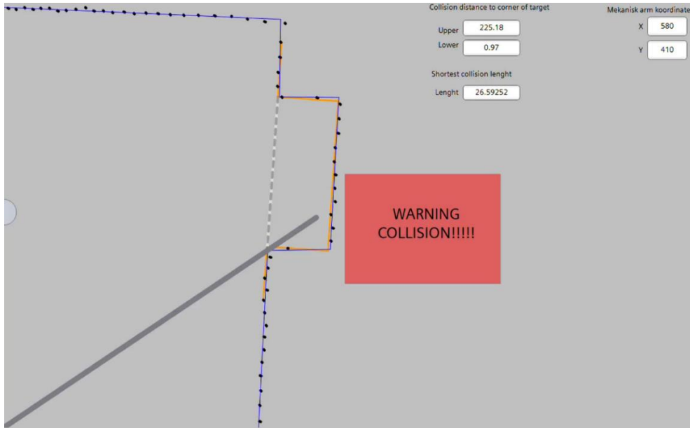
Figur 22 - Utklipp fra HMI-skjermen der du ser at armen har kollidert med det nederste ytre hjørne
