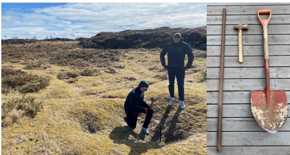
Figur 19 - Gjennomføring av grunnundersøkelser, og utstyr brukt til grunnundersøkelser, Nautøyan 23. april 2024
