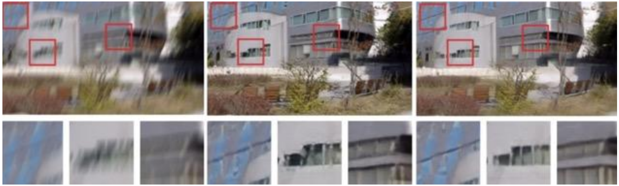
Figur 4.34: Venstre - uskarpt bilde, midten - “deblur”-et bilde med modell av Nah et.al [50], høyre - “deblur”-et bilde med DeblurGAN [14]
