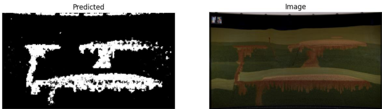
Figur 7-8 - Figuren viser prediksjon gjort av AlexNet modellen, sammen med original rød/grønn bilde den er testet på.
