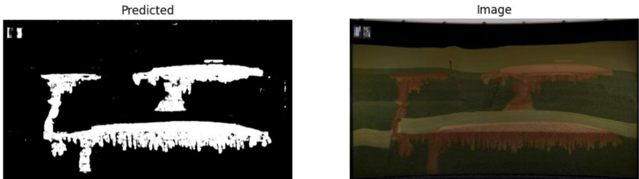
Figur 7-4 - Figuren viser prediksjon gjort av ResNet50 modellen, sammen med original rød/grønn bilde den er testet på.
