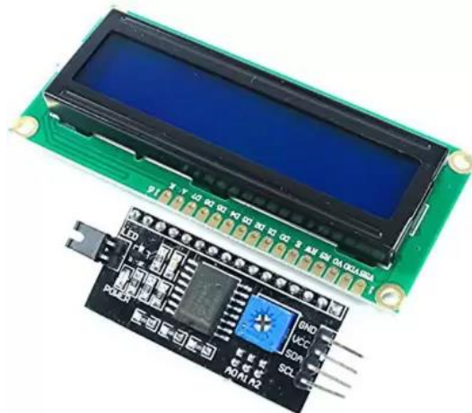
Figur 9: LCD med LCM1602 modul[16]
