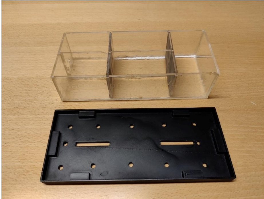
Figur 33: Første utkast av kammerbeholder sammen med første kammerkonsept.
