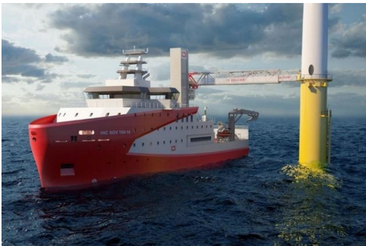
Figur 2: Service Operation Vessel (SOV) oppkoblet til TP. Figuren viser gangveien som strekker seg ut fra skipet til Transition piece. Hentet fra (Energy, IHC Offshore, u.å.)
