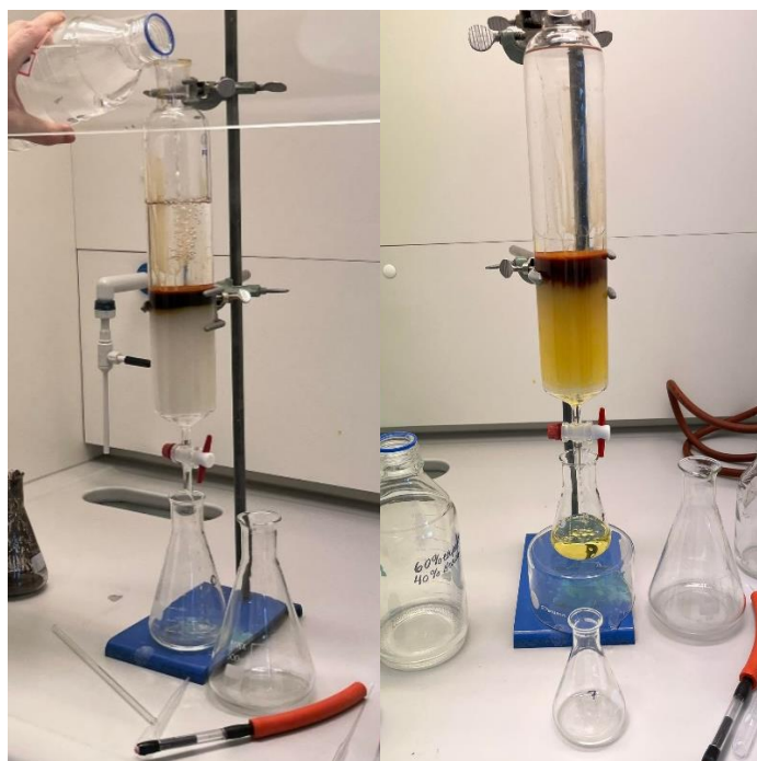
Figur 23. Oppsett av kolonnekromatografi. Bilde tatt av forfattarane av oppgåva.
