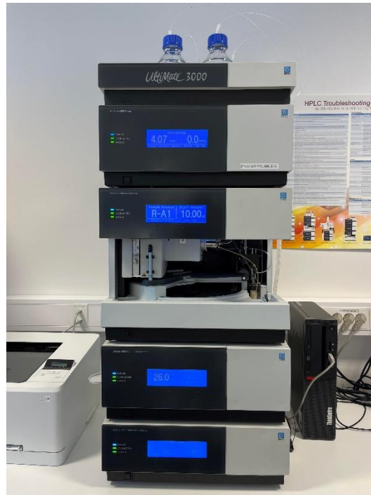
Figur 18. HPLC-instrumentet ved HVL som blei nytta i dette arbeidet. Instrumentet består av ei pumpe, ein trykkdempar, injektor, kolonne og ein detektor tilkople eit datasystem. Bilde er tatt av forfattarane av oppgåva.
