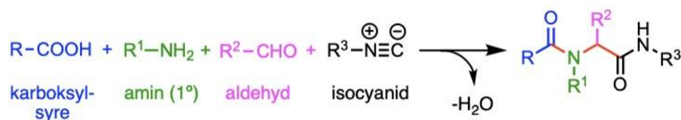
Figur 9. Ugi-reaksjonen. Reaksjonen består av fire komponentar, eit keton, amin, isocyanid og ei karboksylsyre, som danner diamidet.
