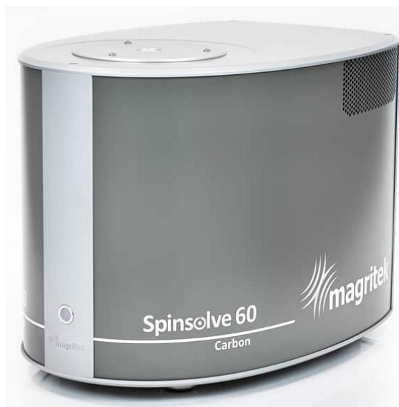
Figur 20. NMR-instrument med permanent magnet som blei nytta i dette arbeidet. Bilde er henta frå Magritek.com .
