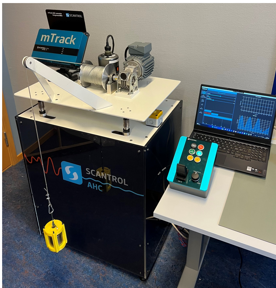
Figur 1.2: Oversiktsbilde over bevegelsesplattform med vinsj, operatørpanel og HMI.
