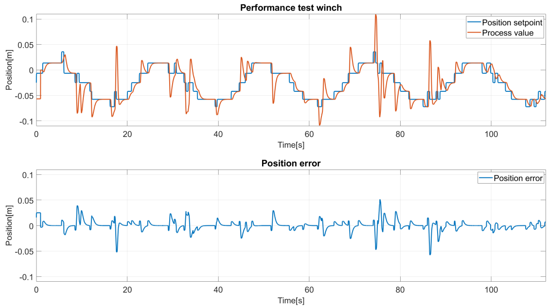
Figur 4.9: Plot som viser ytelsen til AHC ved bruk av stereokamera når plattformen kjører etter simulerte bølger. Den blå, øverste grafen er krantupp sin målte posisjon[m]. Den oransje, øverste grafen viser vinsj bevegelsen, denne er invertert for å tydeliggjøre posisjonsfeil. Den nederste grafen viser den beregnede posisjonen til lasten basert på de to øverste grafene
