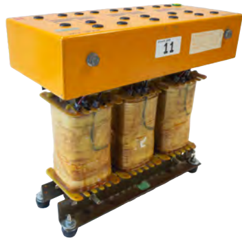
(a) Transformator fra lab
