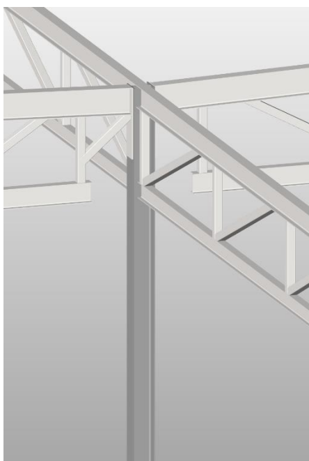
Figur 25 Illustrasjon av innfestning og fastholding topp søyle
