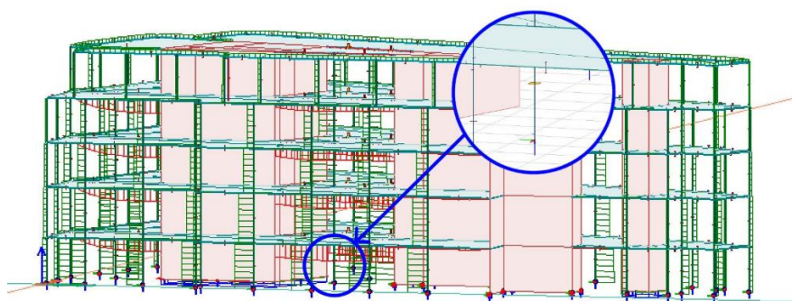
Figur 43 - Plassering av mest påkjent betongsøyle
