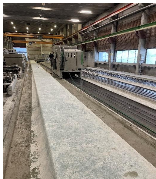
Bilete 3 – Produksjon av hulldekke hjå Nobi på Voss, Foto: Lars Olav Bjørkedal
