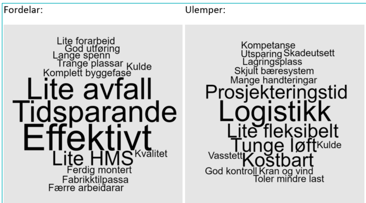
Figur 9 – Høvesvis fordelar og ulemper ved hulldekke
