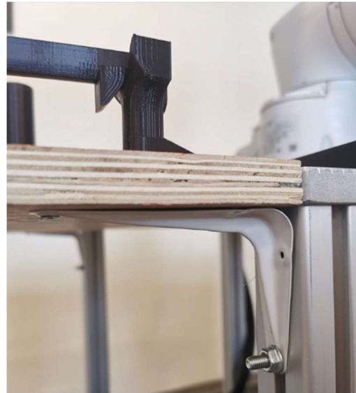
Figur 16 – Festeanordning med T-bolter
