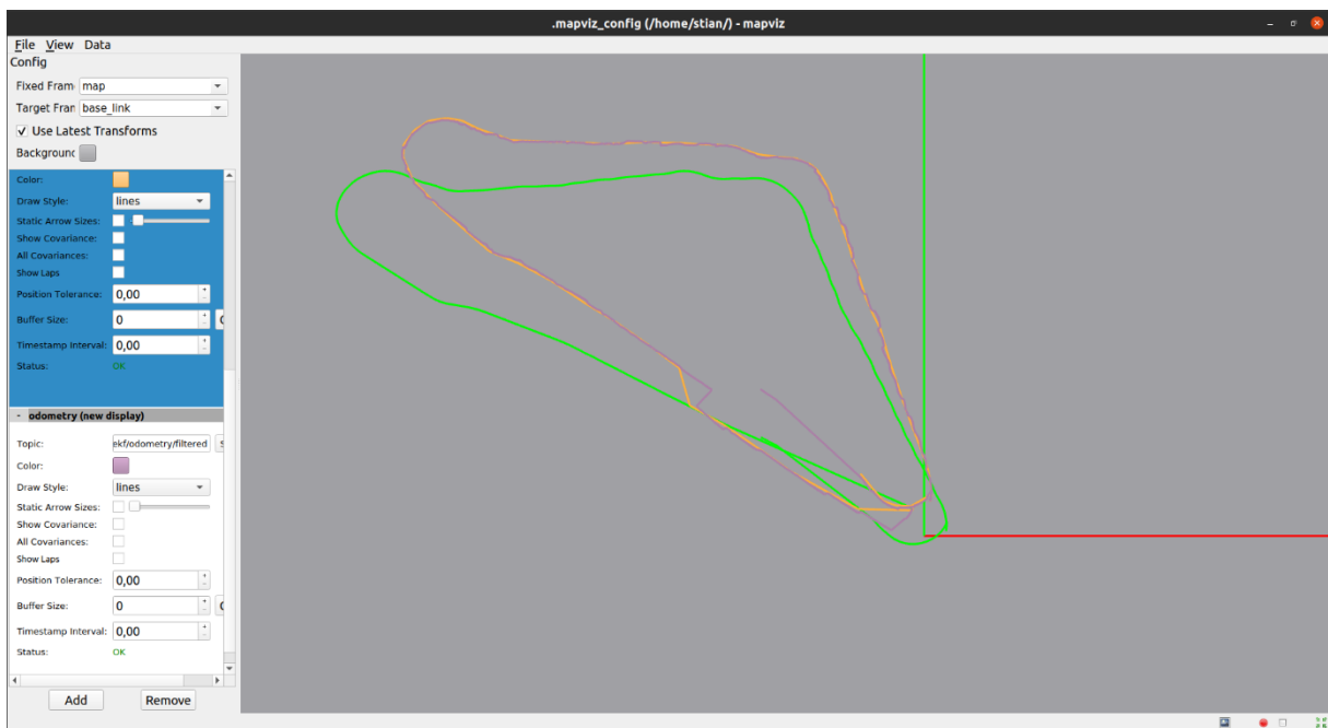
Figur 64: Odometri data for testing i felt visualisert i MapViz.
