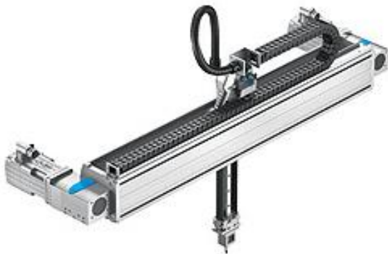
Figur 24: Festo lineær gantry robot lignende til drillen. Kilde: [24]
