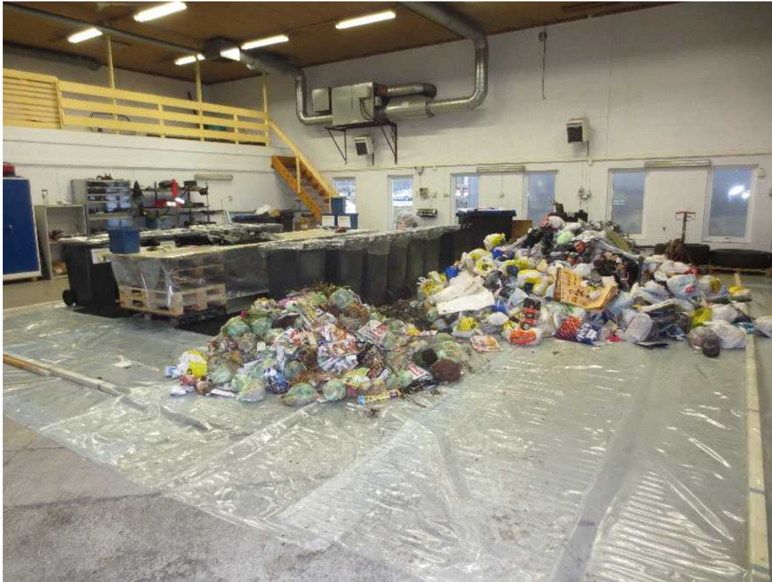
Bilde 1 Ferdig tilrigget sorteringsbord, sorteringsbeholdere, innsamlet bioavfall (i forgrunnen) og restavfall (til høyre).
