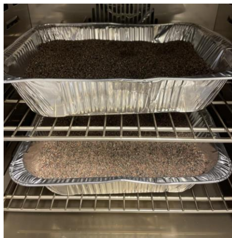
Figur 37 - Varmebehandling av steinsand
