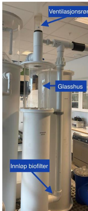
Figur 19 - Utforming av biofilter.
