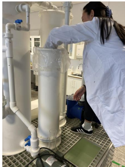
Figur 36 - Tilsetning av sand i biofilter
