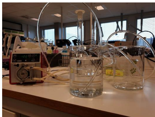
Figur 34 - Rengjøring av peristaltisk pumpe
