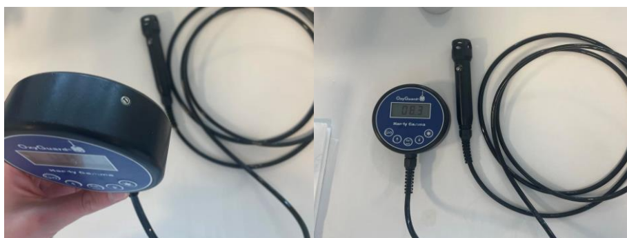
Figur 27 - Oksymer og justerings skruen
