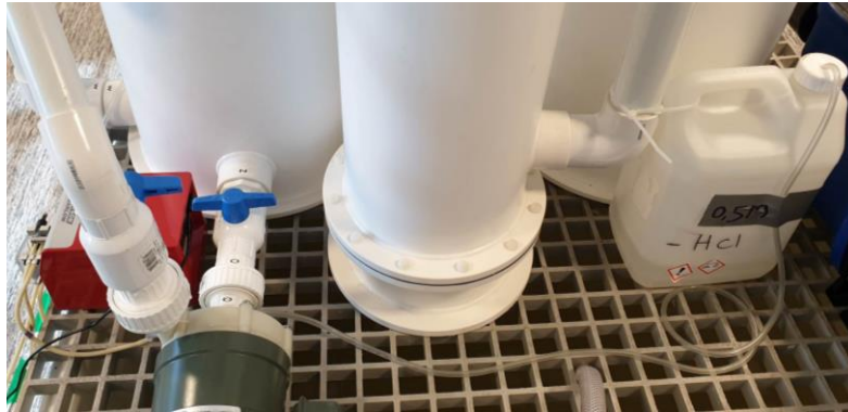
Figur 38 - Oppsett av peristaltisk pumpe og beholder med saltsyre løsning
