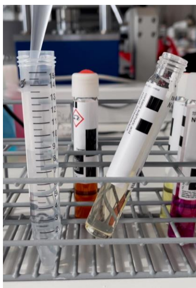
Figur 33 - Skråstilt reagensrør til nitratanalyse
