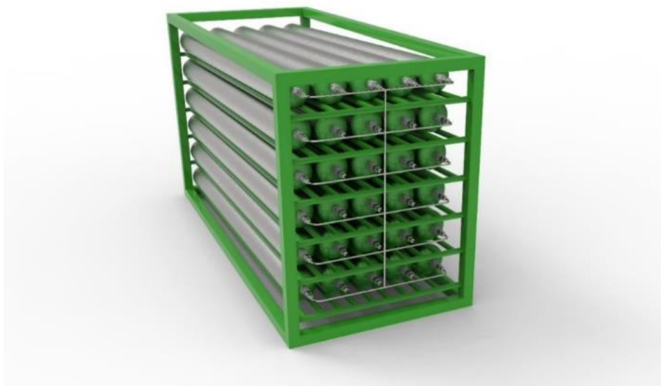
Figur 10 – Fremstilling av en modul med 30 MH-sylindere, og en total lagringskapasitet på 21 kg hydrogen. og dimensjonering i meter på 0.7 x 1.7 x 0.9 (lende x bredde x høyde).
