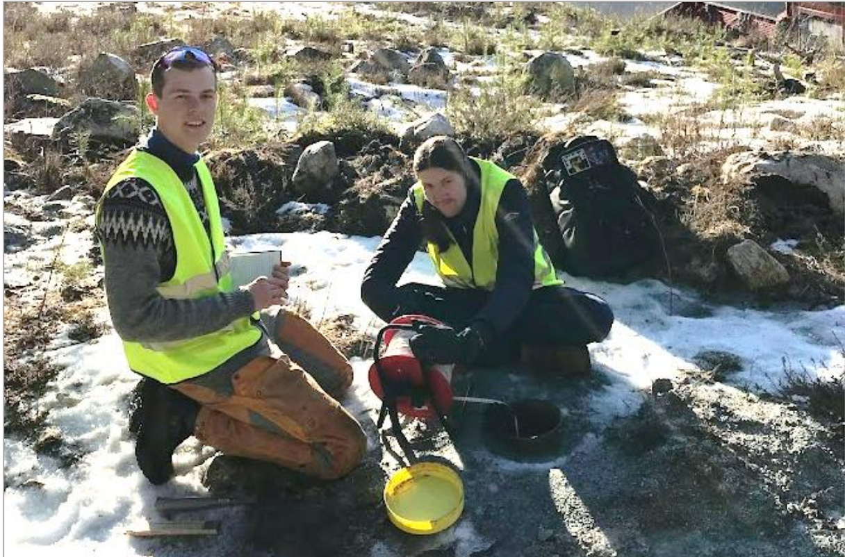
Figur 15: ELoT-analyse i Brønn øst med et interfacemeter.
