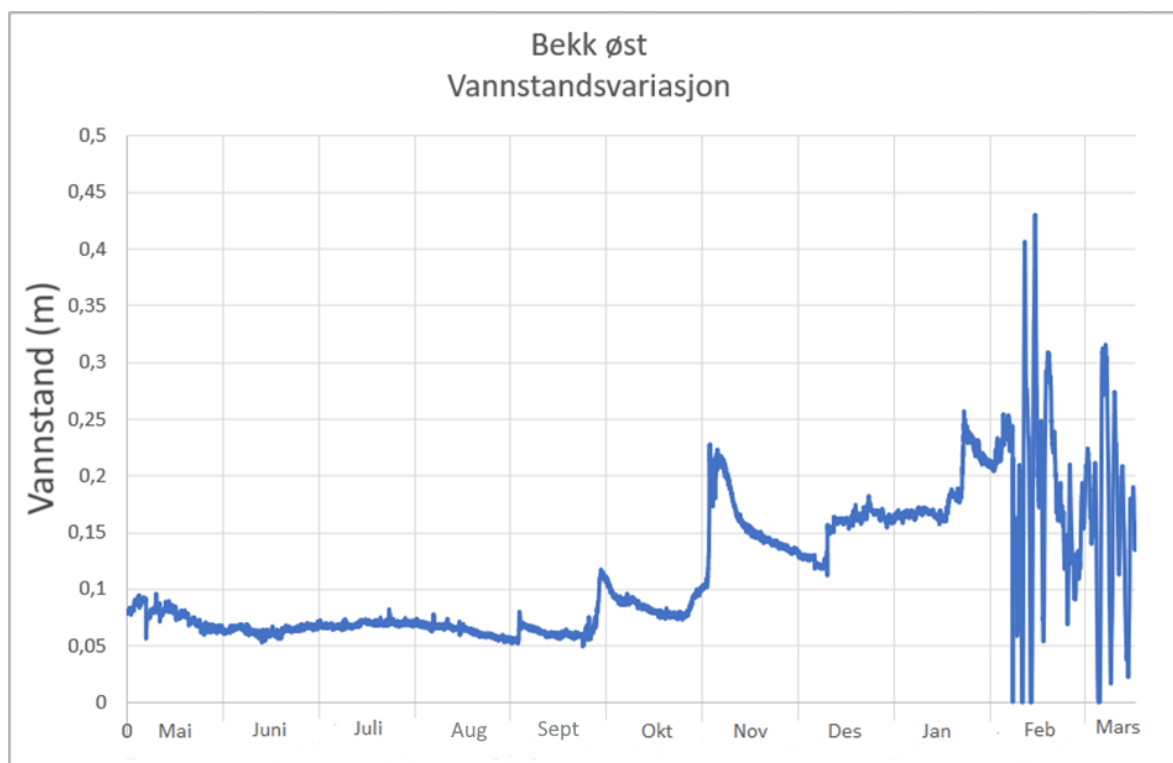
Figur 18: Vannstandsvariasjon i Bekk øst. Atmosfærisk trykk er filtrert vekk.
