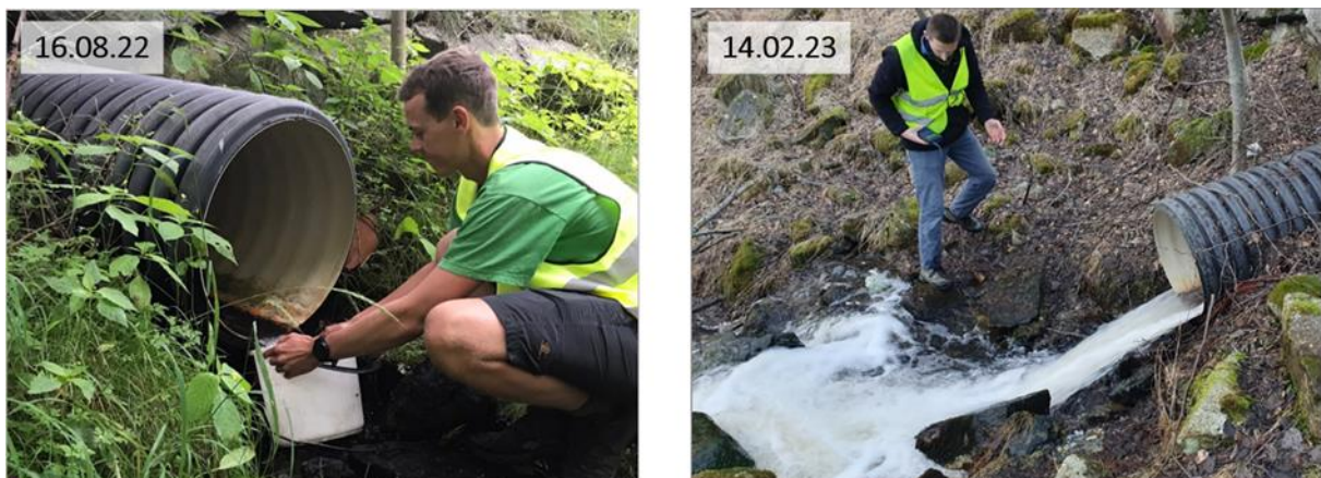
Figur 12: Til venstre vises måling av overflateavrenning med bøtte ved lav vannføring i Bekk ned, og til høyre et bilde fra samme bekken ved høy vannføring. Selv om vannet var lett å fange på nedsiden av stikkrennen, var bekken uegnet for manuelle måling fordi vannføringen til tider var for stor for metoden.
