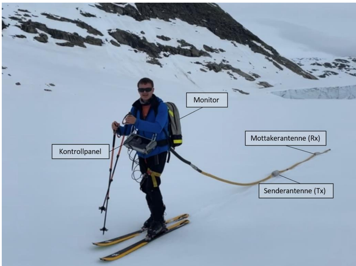
Figur 6: Viser oppsett av Malå georadar og hvordan det fungerer i felt. Personen drar med seg antenne bak seg, og kontrollerer datainnsamlingen fra kontrollpanelet.
