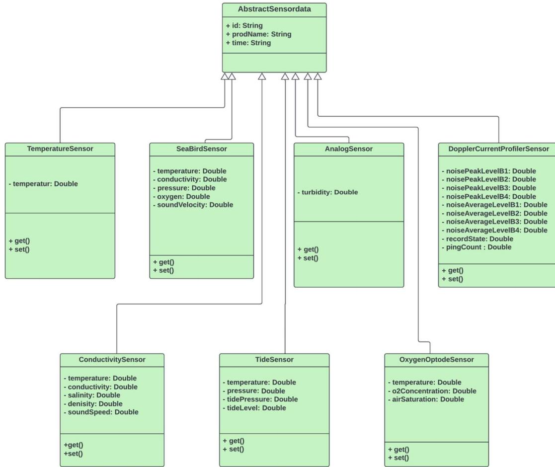
Figuren under viser et klassediagram for de fleste klassene i applikasjonen med unntak av klassediagrammet som er vist over.
