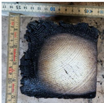
Figur 5-15: Forsøk #17, søyle V3: Noen cm under toppen er det upåvirket trevirke (20-30 cm)
