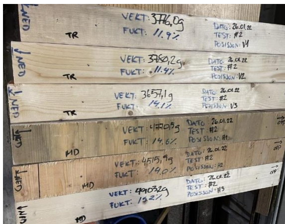
Figur 9-2: Merking av forsøksstykkene
