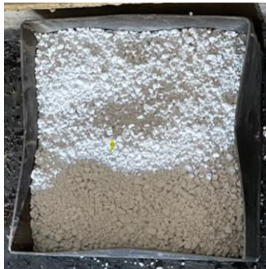
Figur 5-26: Kattesanden i brenneren ble byttet før forsøk #18 til ny type.
