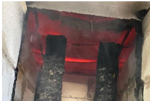
Figur 4-48: Bilde er tatt rett etter vann er hevet inn i rommet. Takplatene er rødglødende (forsøk #19).
