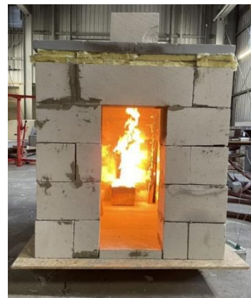
Figur 3-4: Ferdig forsøksrom med takplate
