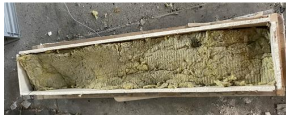
Figur 3-20: Boks med innvendig isolasjon over forsøksstykke
