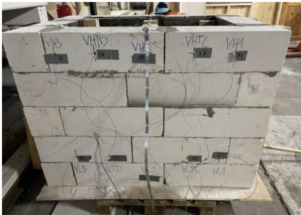
Figur 3-16: Venstre side av ISO-rom, sett fra dør åpningen; Viser plasseringen av termoelementene.
