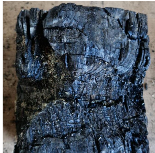
Figur 5-28: Bilde fra forsøk #16, søyle V1 viser sprekk i søyle med aske.
