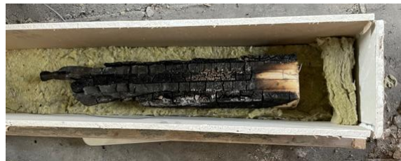
Figur 3-21: Boks med innvendig isolasjon under forsøksstykke
