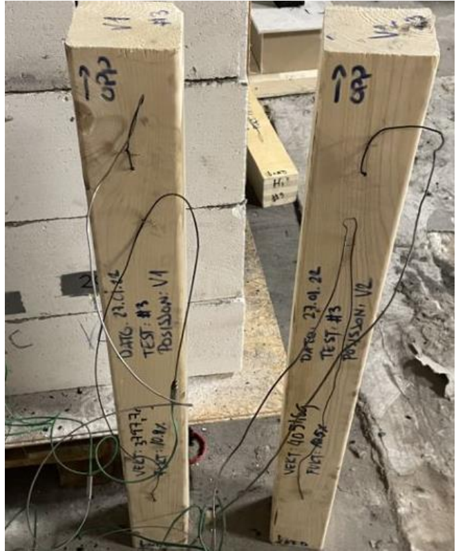
Figur 3-15: Temperaturelementer festet til prøvestykker
