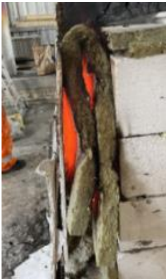
Figur 4-51: Forsøk #5, hull mellom tetning materiell og forsøksrommet.
