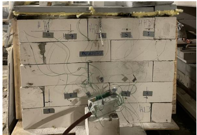
Figur 3-17: Høyre side av ISO-rom, sett fra dør åpningen; Viser plasseringen av termoelementene.
