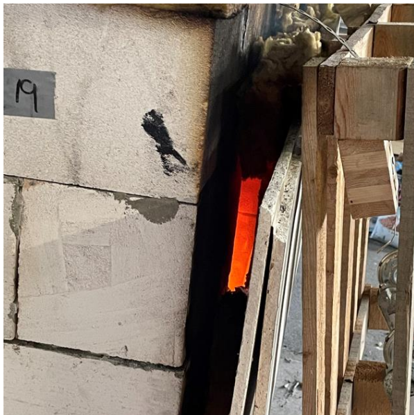
Figur 4-36: Mellomrom mellom rom og gipsplate.
