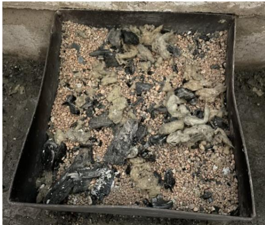
Figur 5-21: Innholdet i brenner etter forsøk #9. Bilde er tatt før brenneren ble renset.
