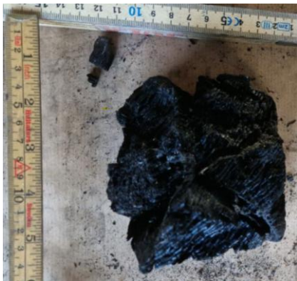
Figur 5-14: Forsøk #17, søyle V3: Øvre del av søylen (30-40 cm)
