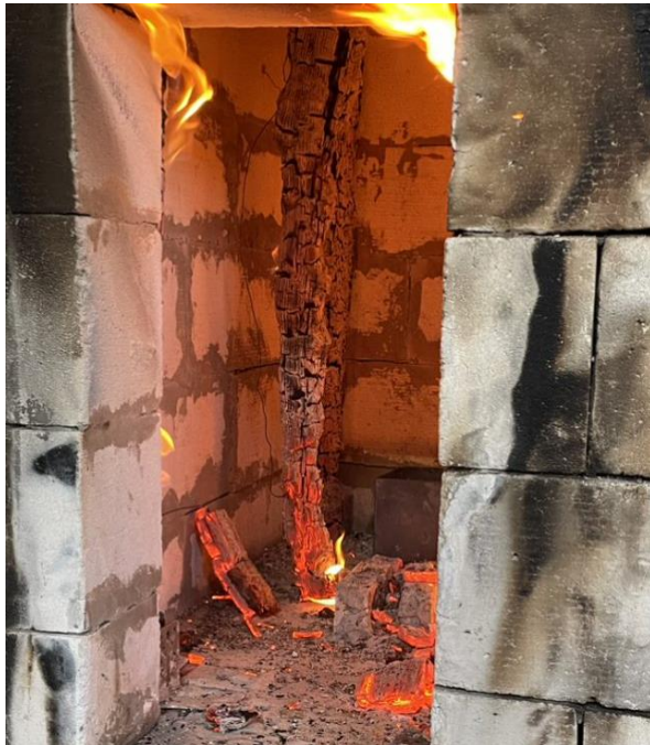
Figur 5-17: Bilde er tatt inn gjennom den åpne døren under forsøk #10. Viser søyle V2 som er plassert i midten av rommet. Rundt den nedre delen av søylen kan de observeres lameller som har falt av. Den nedre delen av søyle V2 har en mindre gjenstående diameter en den øvre del av søylen.
