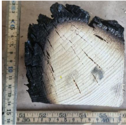
Figur 5-12: Forsøk #2, søyle V3: Noen cm under toppen er det upåvirket trevirke (60-70 cm)
