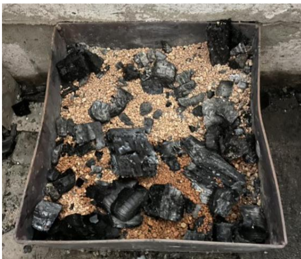
Figur 5-23: Tilstanden oppi brenneren etter forsøk #10 var ferdig. Deler av sanden er mørkere grunnet vann som er påført flammene.
