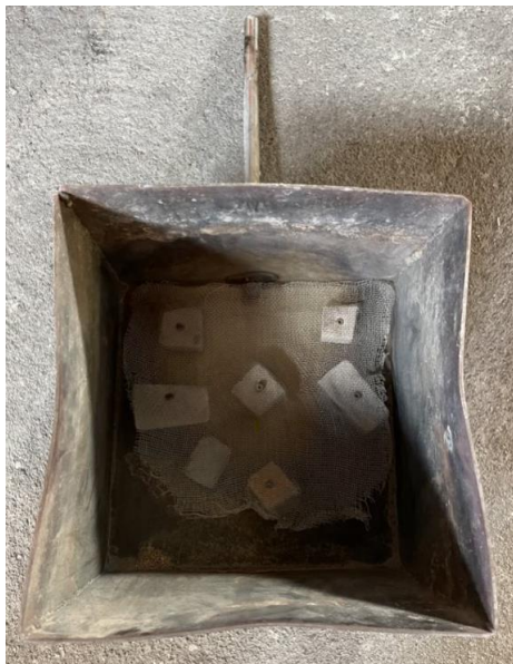
Figur 5-25: Brenneren ble tømt før forsøk #13 og #16. Nettingen dekker ikke hele arealet til brenneren.
