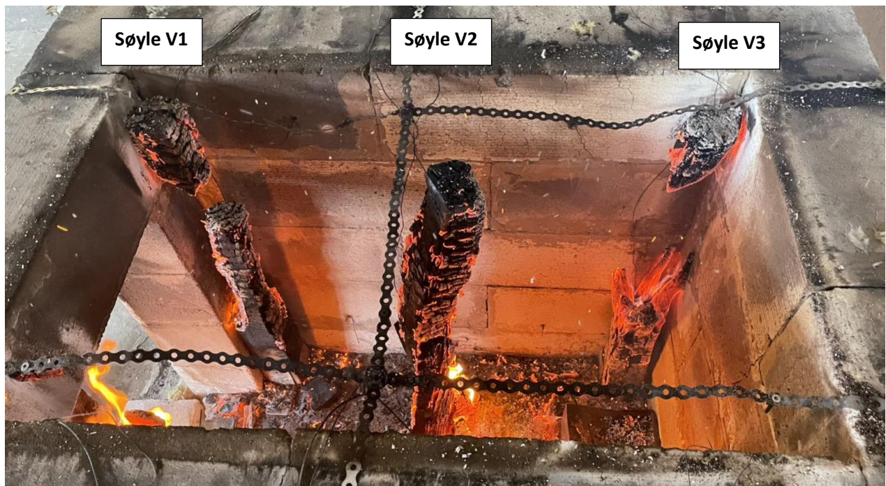
Figur 4-30: Venstre side av forsøksrommet, sett oven i fra. Bilde viser tilstand i forsøksrommet rett etter taket er fjernet. Etter bilde ble tatt ble de påført vann for å kjøle ned søylene.
