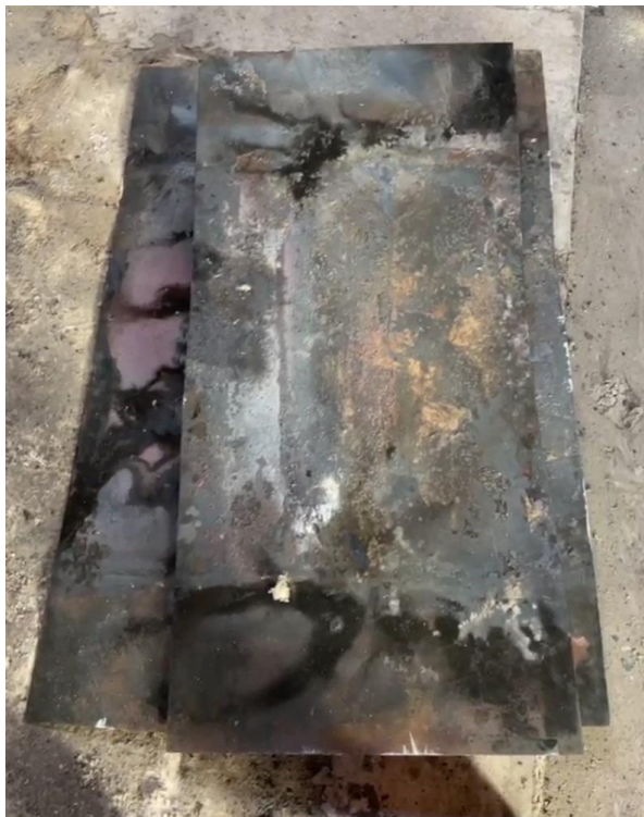
Figur 5-19: De tre stålplaten viste etter forsøk 9 var gjennomført tydelige tegn til deformasjon.
