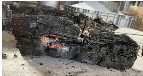
Figur 4-39: Søyle V2 etter den var fjernet fra rommet (ca. 35 minutter etter taket var fjernet).
