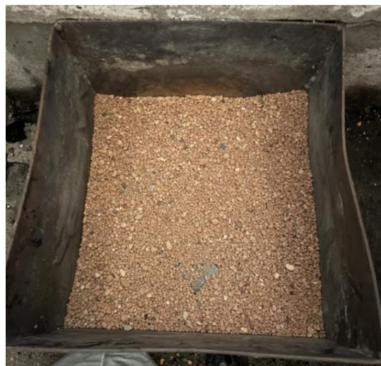
Figur 5-24: 90 % av kattesanden ble byttet ut før forsøk #11. De nederste laget som var plassert over nettingen ble ikke fjernet.
