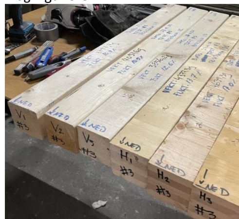
Figur 9-3: Merking av bunnen av forsøksstykkene
