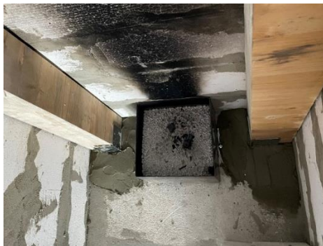
Figur 3-8: Plassering av de bakerste prøvestykkene, samt brenner. Sett gjennom takåpningen.
