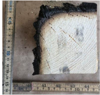
Figur 5-13: Forsøk #2, søyle V3: Noen cm under toppen er det upåvirket trevirke (50-60 cm)
