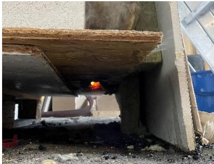
Figur 4-52: Forsøk #5, Det oppstå et hull på undersiden av forsøksrommet, som førte frisk luft inn i rommet.
