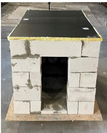
Figur 3-2: Stålplater på toppen av forsøksrommet
