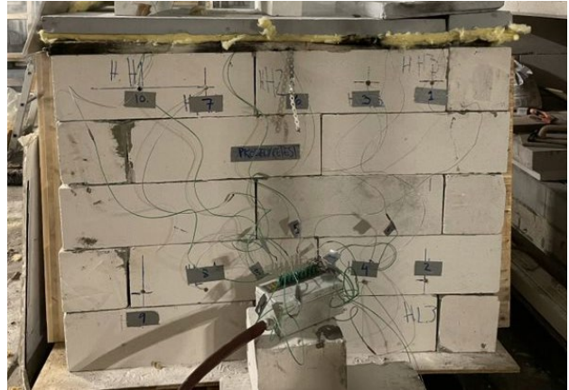
Figur 3-17: Høyre side av ISO-rom, sett fra dør åpningen; Viser plasseringen av tremoelementene.
