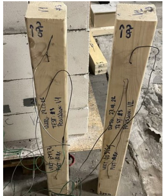
Figur 3-15: Termoelementer festet til prøvestykker
