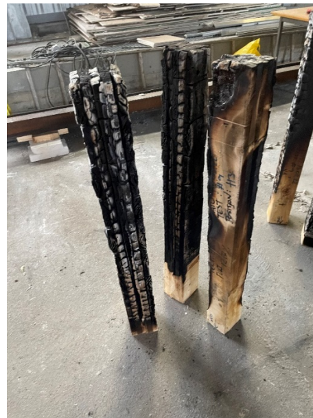
Figur 4-5: Søylor fra forsøk #09. Stykkene ble løftet ut etter ca. 5 timer
