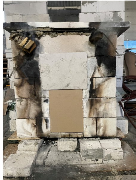
Figur 4-3: Dør til brannrommet steng med gipsplate (Fra forsøk #07)
