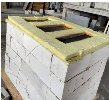
Figur 3-3: Isolasjon plassert over stålplater
