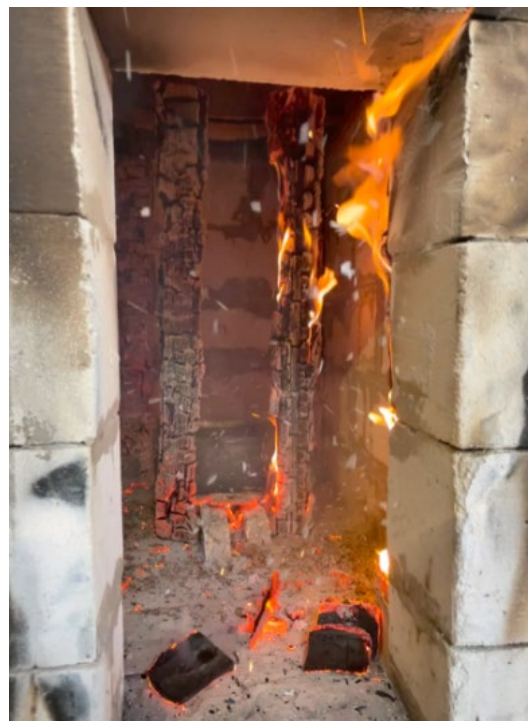
Figur 5-12: Delaminering i forsøk #10
