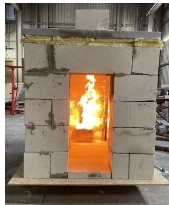
Figur 3-4: Ferdig brannrom med takplate
