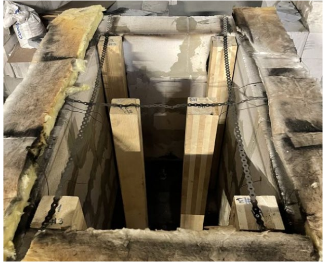
Figur 3-13: Prøvestykker plassert i brannrommet
