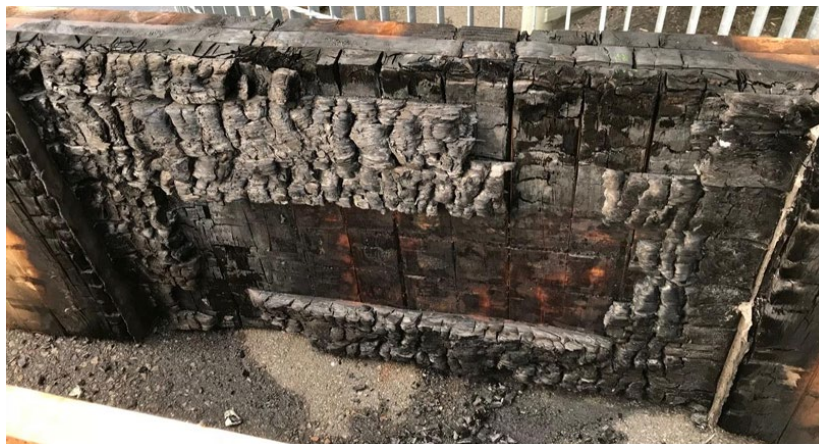
Figur 2-5: Forkullet KLT med eksempel på delaminering (Bilde fra [18])
