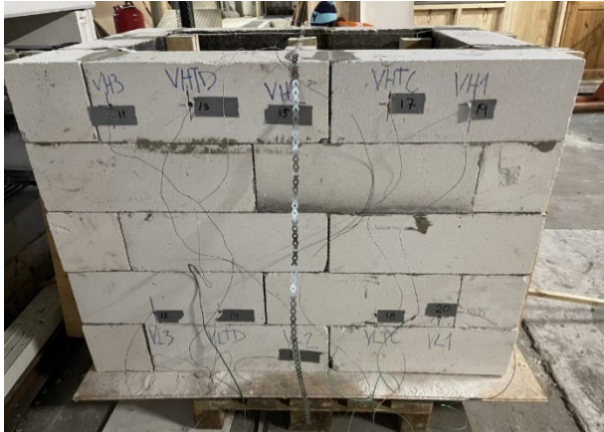
Figur 3-16: Venstre side av ISO-rom, sett fra dør åpningen; Viser plasseringen av tremoelementene.
