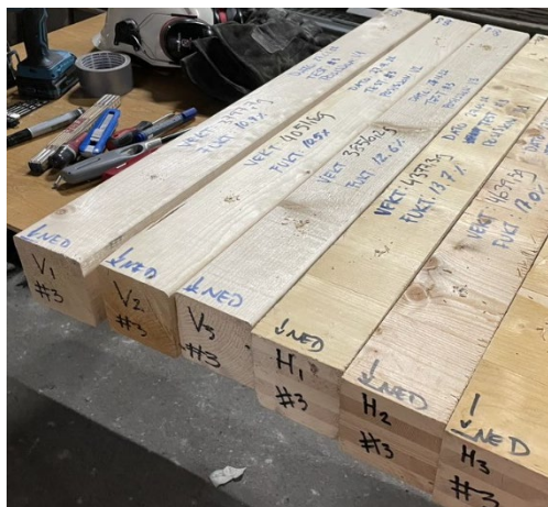
Figur 1-3 Merking av bunnen av søylene
