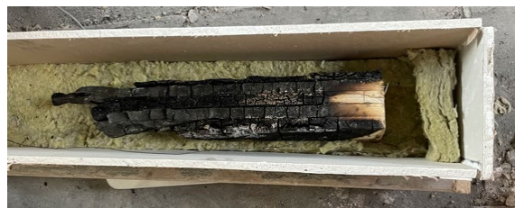
Figur 3-21: Boks med innvendig isolasjon under søylen
