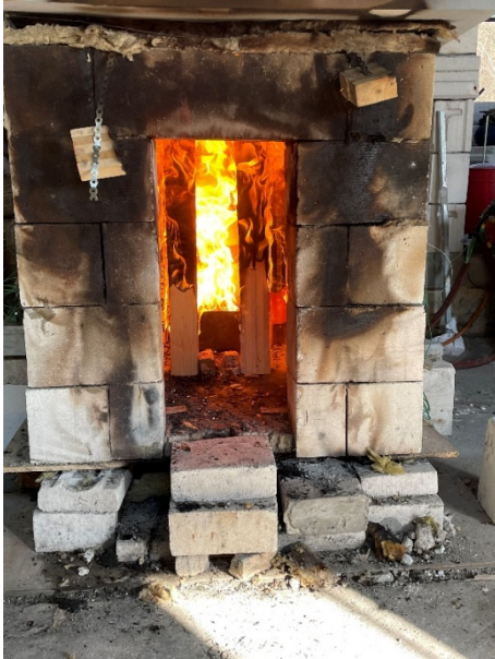
Figur 4-2: Initiell brann ( t < 20 \text{ min} ) observert gjennom brandør
