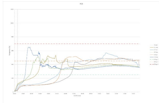
Figur 1-12: Sammenligning av tid/temperaturkurver for søyler i #18 mot temperaturkriteriet for ulming
