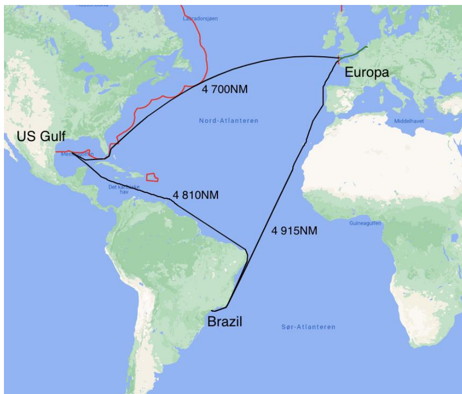
Figur 8 – Planlagt seilingsrute for Grieg Star sin L-klasse med ammoniakk som drivstoff hvor det må bunkres i hver havn, basert på 10-15 knop (figur er rekonstruert fra rapporten (Grieg Star, 2023))
