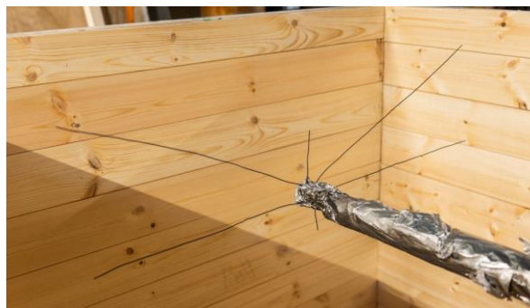
Figur 18: Termoelementene ble montert på en fast rigg.
