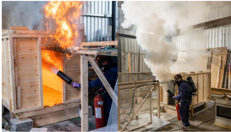
Figur 23: Etter overtenning i rommet ble brannen slokket med CO 2 -apparat.
