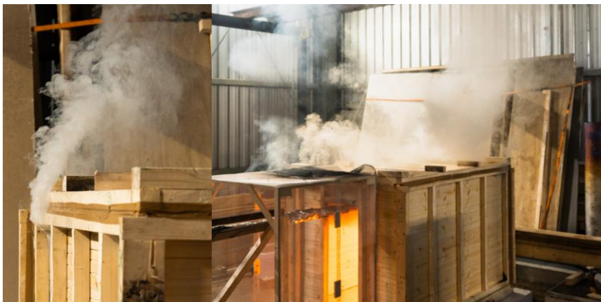
Figur 21: Lekkasje av branngasser er en feilkilde i forsøkene. Det var vanskelig å tette byggverket tilstrekkelig med den valgte metoden.
