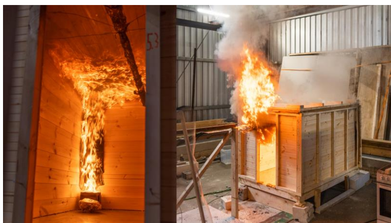
Figur 22: Brannutvikling på et tidlig tidspunkt inne i rommet t.v. og overtenning sett utenfra rommet t.h.
