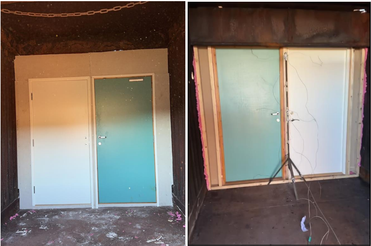
Figur 12: Viser begge sider av veggen før brenning
