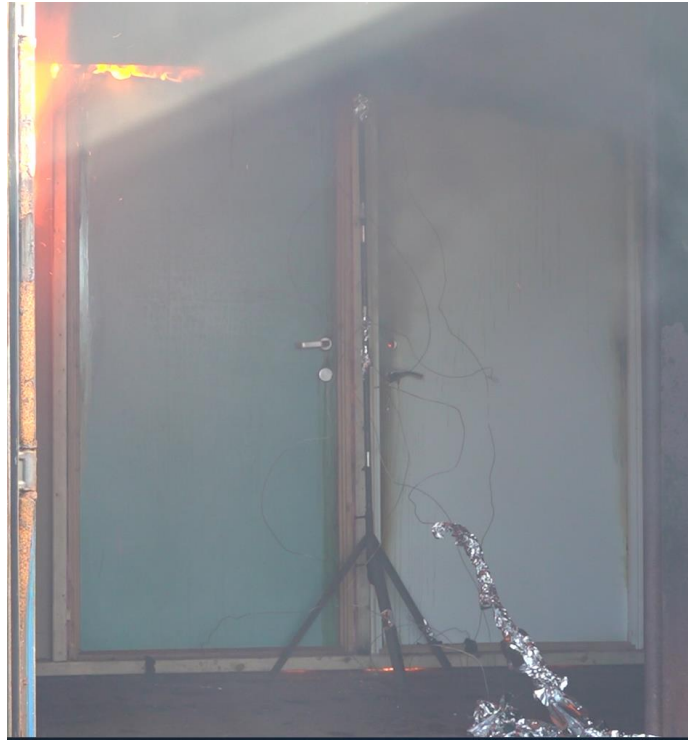
Figur 22: Viser situasjon på ueksponert side etter 16 minutter.
