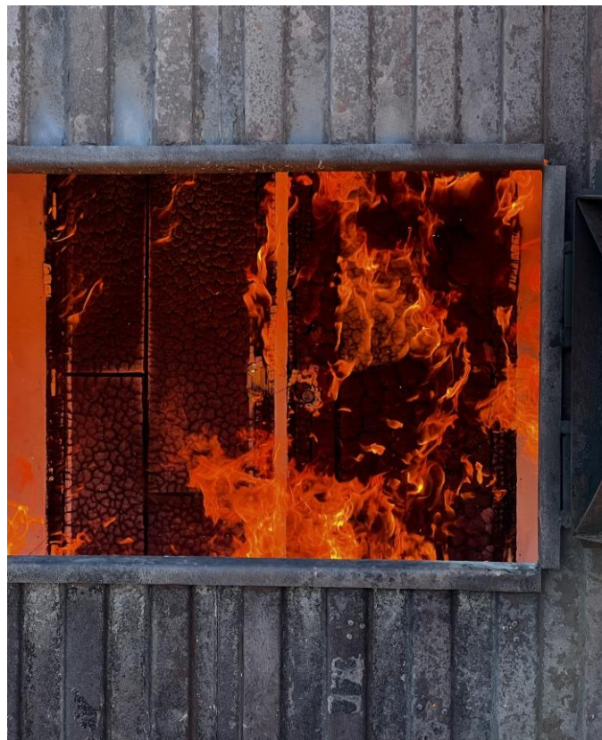
Figur 26: Viser forkulling av dørene fra eksponert side etter ca. 30 minutter.
