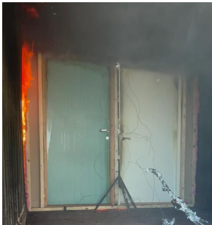
Figur 21: Viser situasjon på uekspontert side etter ca. 10 minutter.
