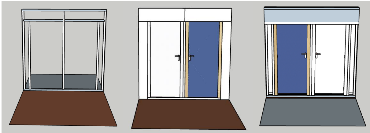
Figur 17: Disse bildene viser oppbygning av vegg. FV: Illustrasjon av reisverk, illustrasjon av siden mot brannen og illustrasjon av baksiden.
