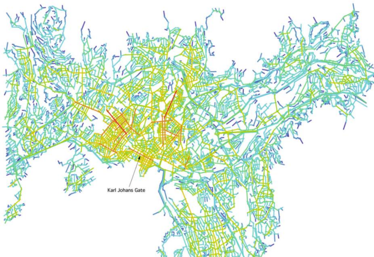
Figur 33 Lokal 'axial integration' analyse av Oslo, r=3 . Kilde: van Nes & Yamu (2021, s. 56)
