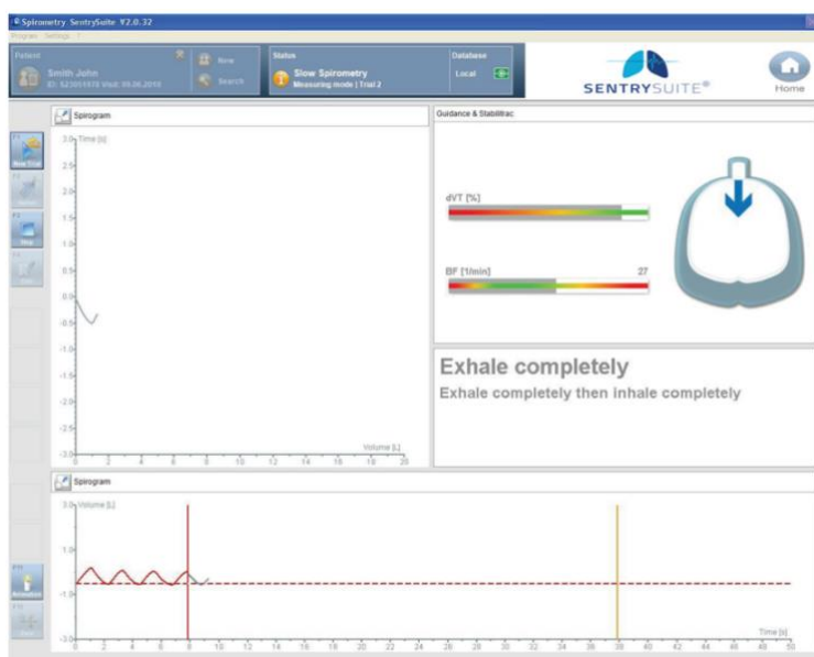
Figur 9. Spirogramvindu fra SentrySuite MasterScreen (differensialtrykkensensor) ved lungefunksjonstesting. De fargede føringslinjene øverst til høyre på bilde sier noe om utåndingstiden og platåpåkjenningen. Etter minimum fem jevne pust vises en rød striplet linje sammen med to vertikale linjer på spirometerets spirogramvindu. Fra «SentrySuite, software platform for intelligent respiratory diagnosis» av Vyair Medical Inc. (2019), s. 4.
