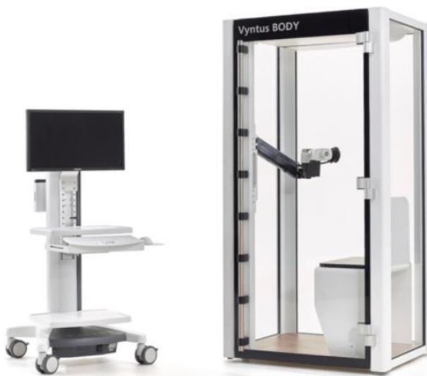
Figur 7. SentrySuite Vyntus Body er et stort, stasjonært spirometer som er konstruert i et kabinett med digital trykkompensasjon. Dette spirometeret har forbedret innovasjon som skal bidra til å begrense miljøpåvirkning og forbedre målenøyaktigheten. Spirometeret gir mulighet for konvensjonelle spirometriske målinger, i tillegg til pletysmografimålinger. Fra "Vyntus™ Body" av (Timik Medical, 2021).
