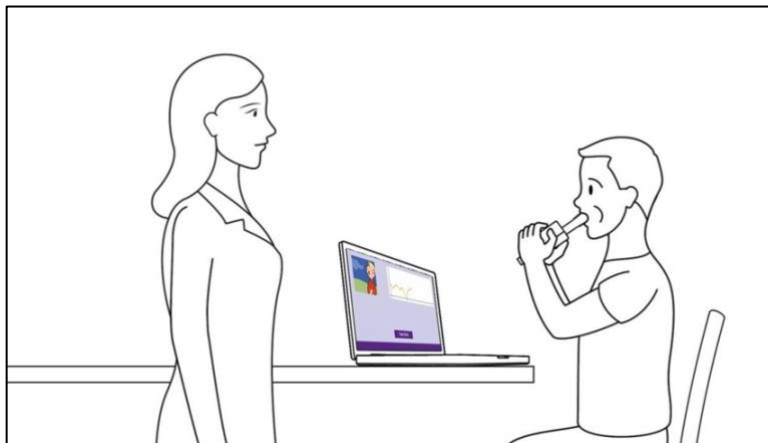
Figur 11. Lungefunksjonstest på EasyOne Air utføres ved at testpersonen selv holder spirometeret. En instruktør skal instruere gjennom hele prosessen, og resultatene overføres trådløst til et lagringsprogram på en intern enhet i spirometeret. Fra «EasyOne Air, Early Diagnosis for Better Lung Health» av (NDD Medical Technologies, 2018).
