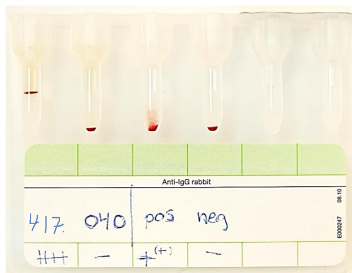
Figur 12. Resultat av utvidet forlik på gelkort. Figuren viser resultatet av utvidet forlik mellom pasient og to ulike blodgivere, samt positiv og negativ kontroll.
