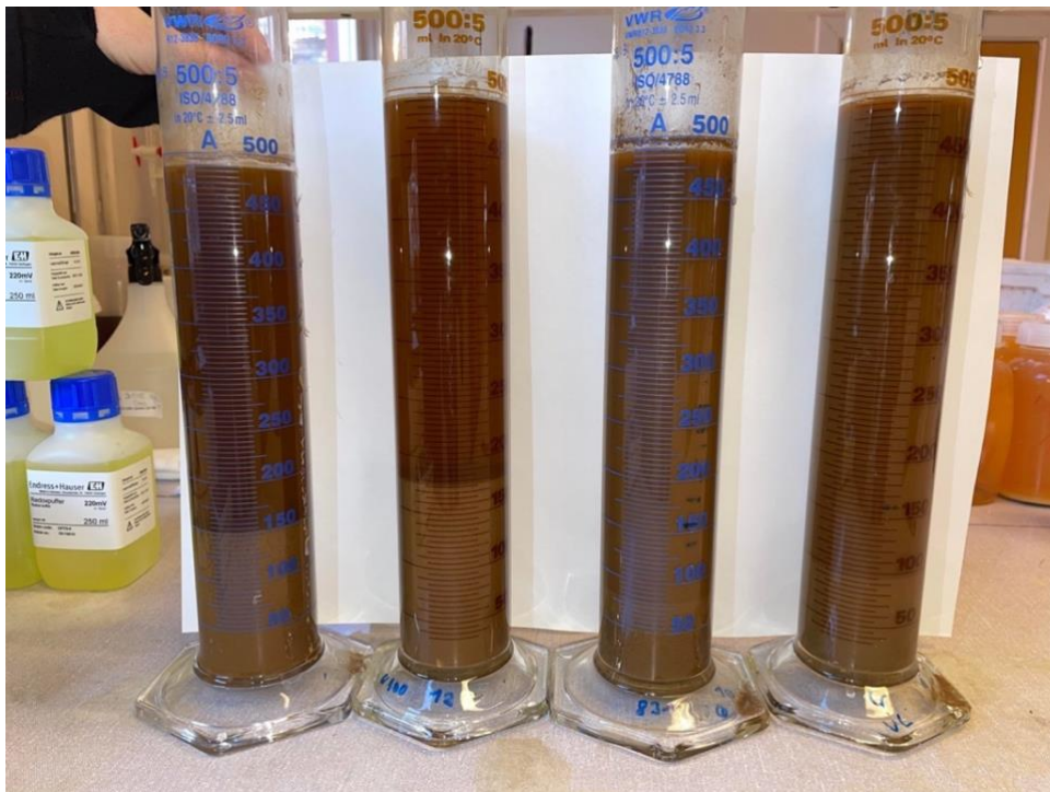
Figur 12 – Etter sedimentering vist i Figur 11 av jarosittløsning fra anlegget. Fra venstre: 15 ml C-595, 15 ml C-577, 15 ml N-100, 15 ml N-300.
