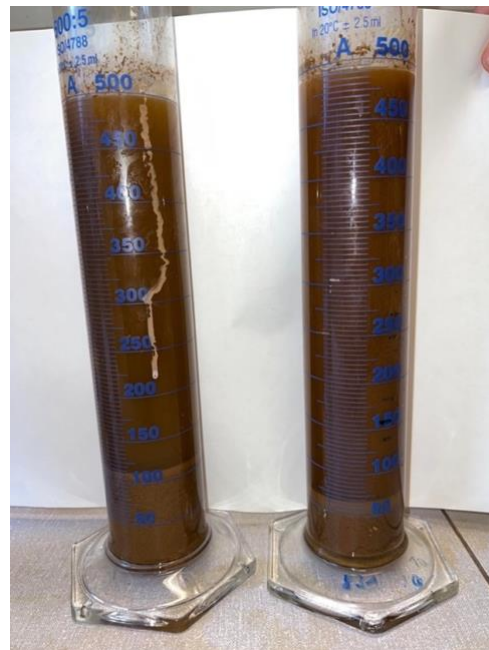
Figur 19 - Etter sedimentering med nøytralslam som nøytraliseringsmiddel og 20 ml N-100 tilsatt. Til venstre er det en kimekonsentrasjon på 60 g/l vist i Figur 17 og til høyre er kimekonsentrasjonen 15 g/l.
