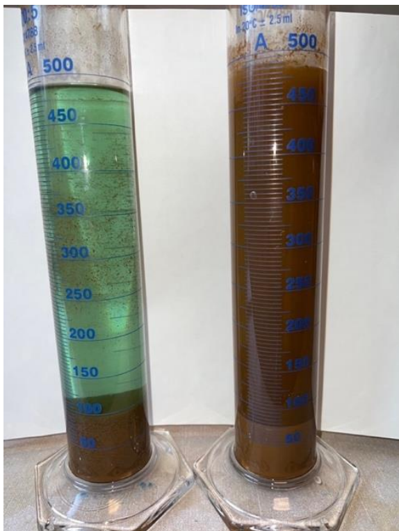
Figur 23 – Etter sedimentering vist i Figur 22 med jarosittløsning produsert på laboratoriet med 60 g/l kimer og 7,5 ml N-100. Til venstre er det tilsatt kalsine som nøytraliseringsmiddel og til høyre er det tilsatt nøytralslam som nøytraliseringsmiddel.
