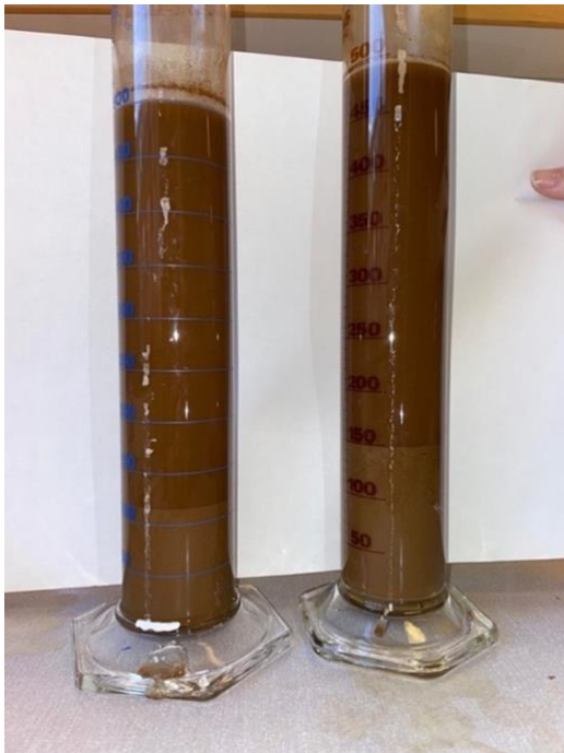
Figur 14 - Etter sedimentering vist i Figur 13 av jarosittløsning fra anlegget med tilsatt 5 ml N-100 flokkulant og 10 ml C-595 koagulant. Til venstre er koagulant tilsatt først og til høyre er flokkulant tilsatt først.
