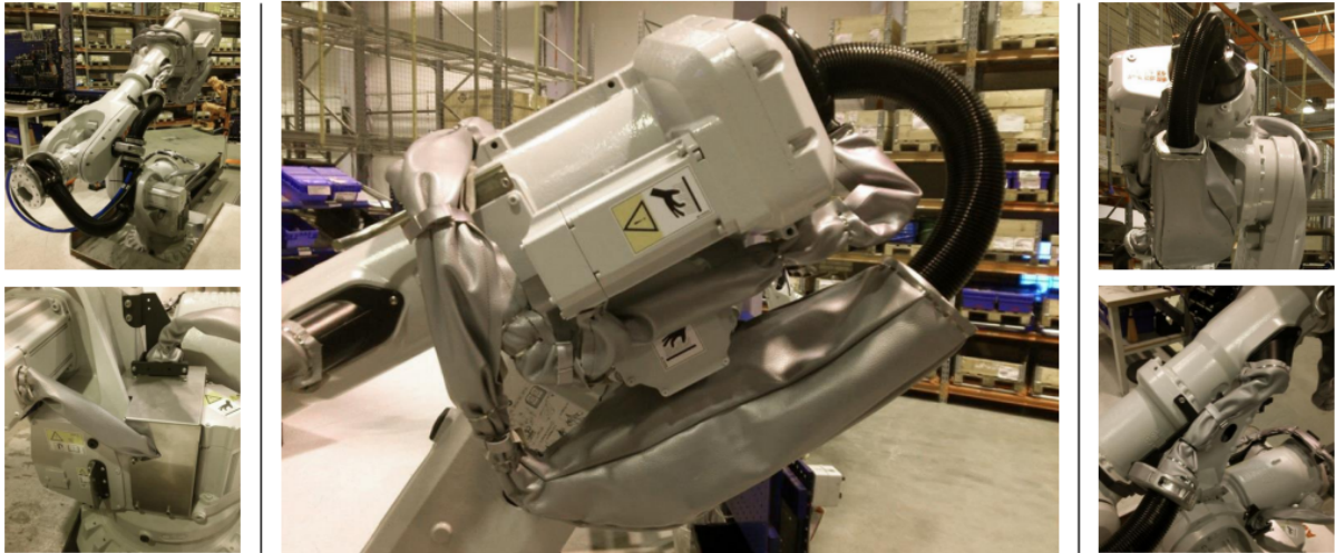
Figur 2.4: ABB IRB med LEAN-ID og foundry plus 2 [16]
