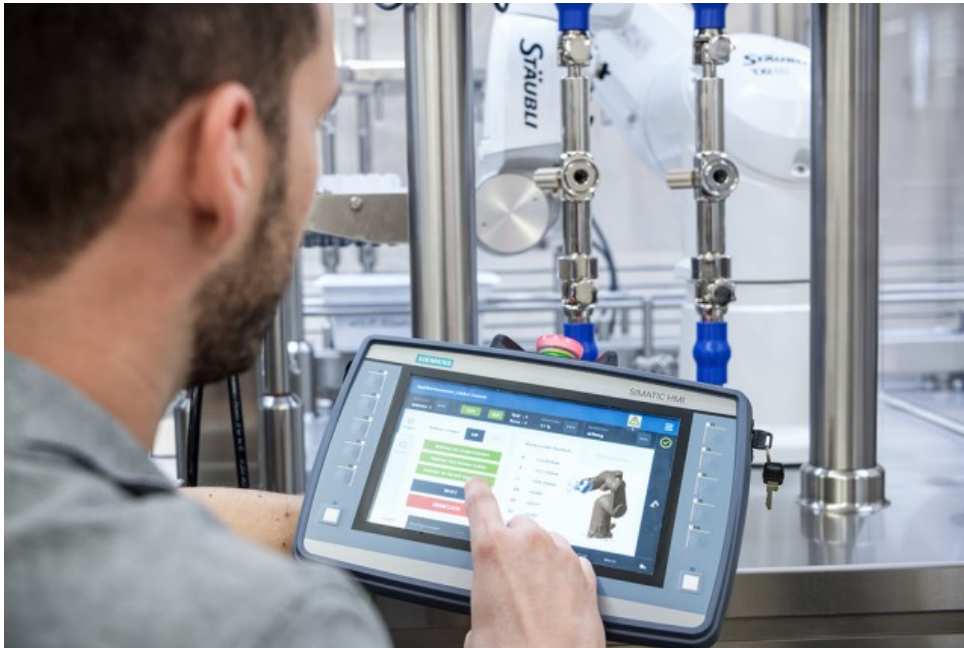
Figur 3.3: Illustrasjon av SIMATIC HMI Mobile Panel sammen med Robot Integrator [36]
