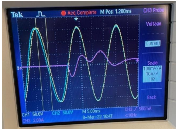
FIGUR 20. FOR -10^\circ FASEVINKEL (BILDE TATT FRA ELKRAFT LAB HVL)
