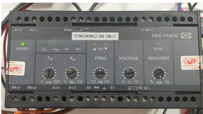
FIGUR 14. DEIF FAS-113DG (BILDE FRA UTSTYR LÅNT FRA SIEMENS ENERGI AS)
