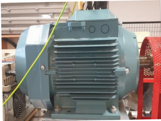
FIGUR 5. PRIME MOVER (BILDE TATT FRA ELKRAFT LAB HVL)
