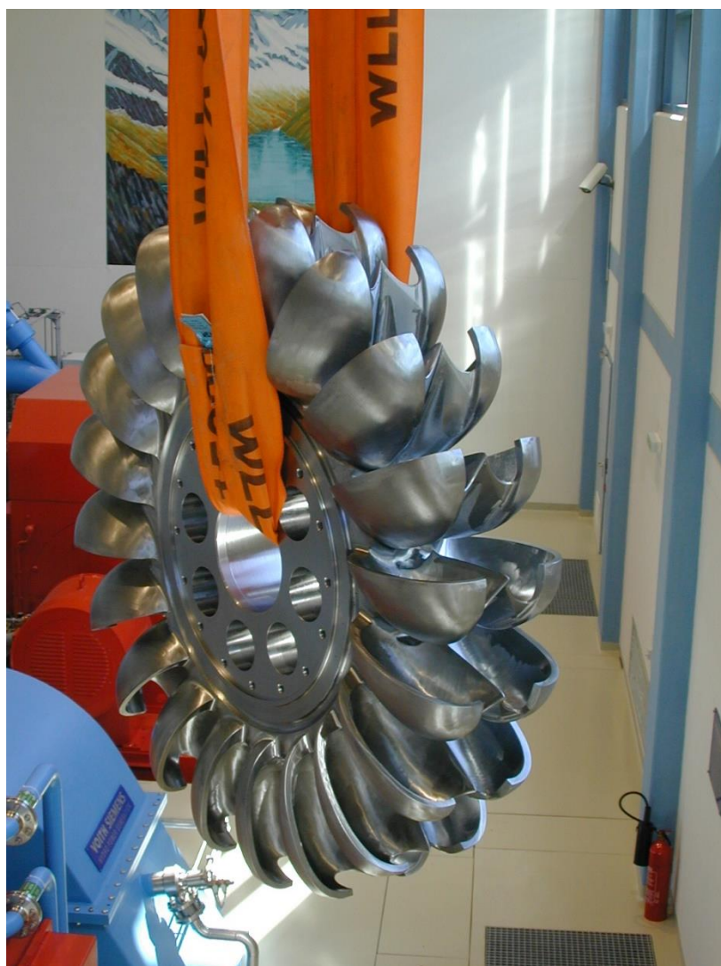
Figur 21 Løpehjulet til en peltonturbin
