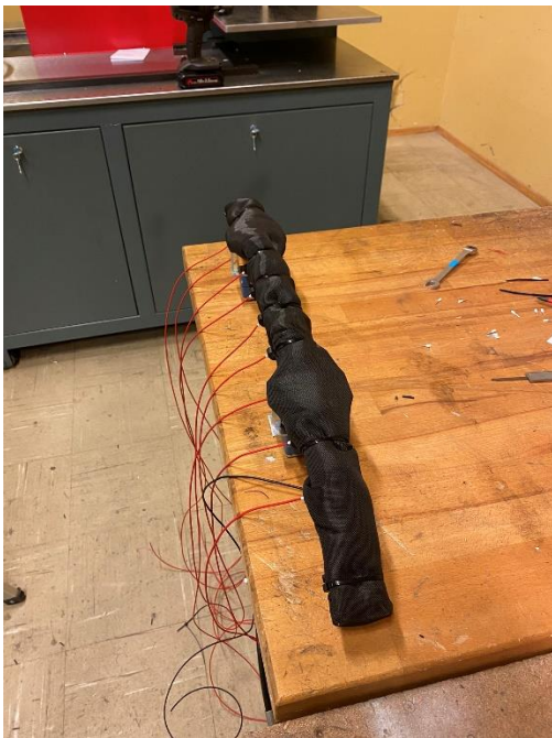
Figur 54: Frontfanger tildekket og klar til montering og funksjonstest i Leikanger
