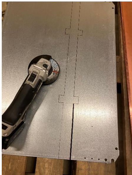
Figur 48: Metallplate ferdig oppmålt og klar for utskjæring
