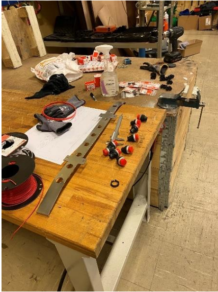
Figur 49: Frontfanger ferdig pusset og med hull til brytere
