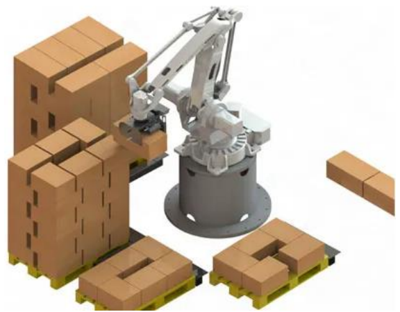
Figur 1 RoboPall - Industriell ABB robot for plassering av bokser. Hentet fra: https://robotmorge.no/applikasjoner/
