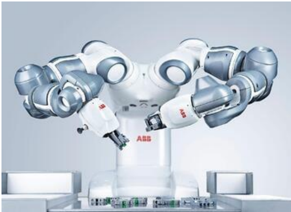
Figur 4 ABB YuMi, en samarbeidende robot med to armer Hentet fra: https://new.abb.com/es/tecnologia
