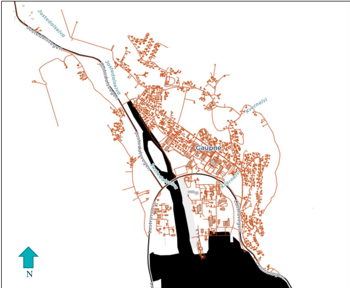
Figur 19: Illustrasjonsbilde av fjernvarmenettverket i Gaupne for scenario 3. Dei oransje linjene illustrera røyra i nettverket. Utklipp frå THERMOS.
