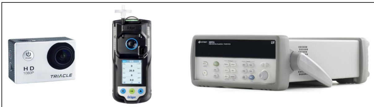
Figur 22: Målingsutstyr fra venstre: action kamera, multigassdetektor og datalogger.
