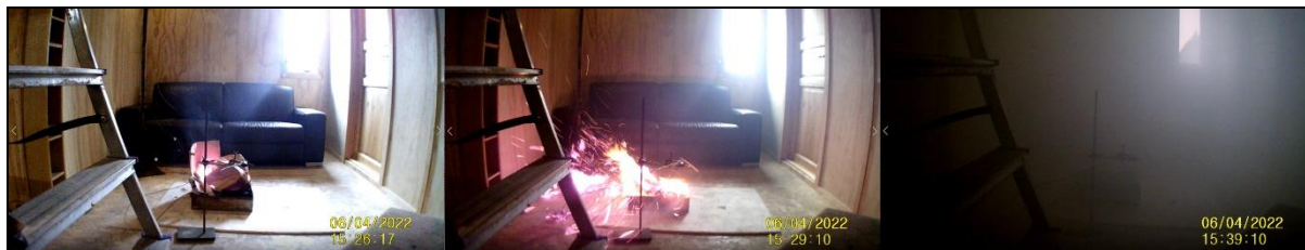
Figur 38: Fra venstre: Kort tid etter antennelse, utløsning IG-541 og 10 minutter etter utløsning – Forsøk A3
