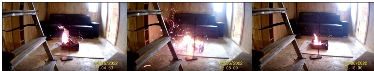
Figur 30: Fra venstre: Kort tid etter antennelse, utløsning IG-541 og 10 minutter etter utløsning – Forsøk A1
