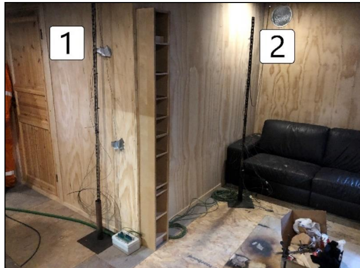
Figur 21: Stativ med termoelementer: (1) kjøkken og (2) stue
