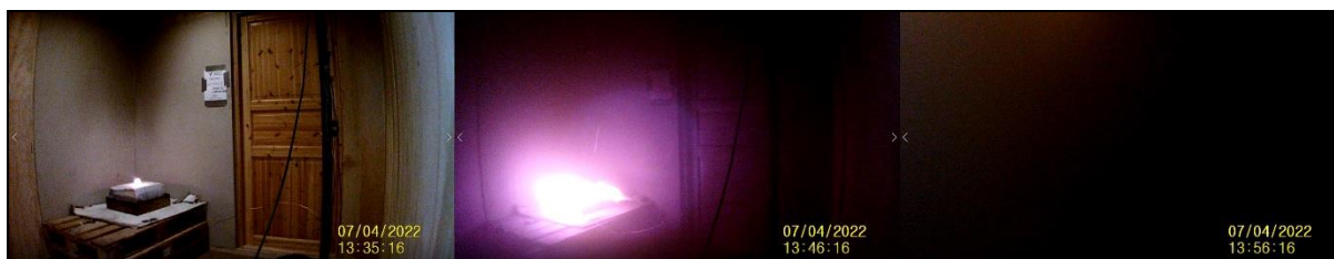
Figur 46: Fra venstre: Kort tid etter antennelse, utløsning IG-541 og 10 minutter etter utløsning – Forsøk B2
