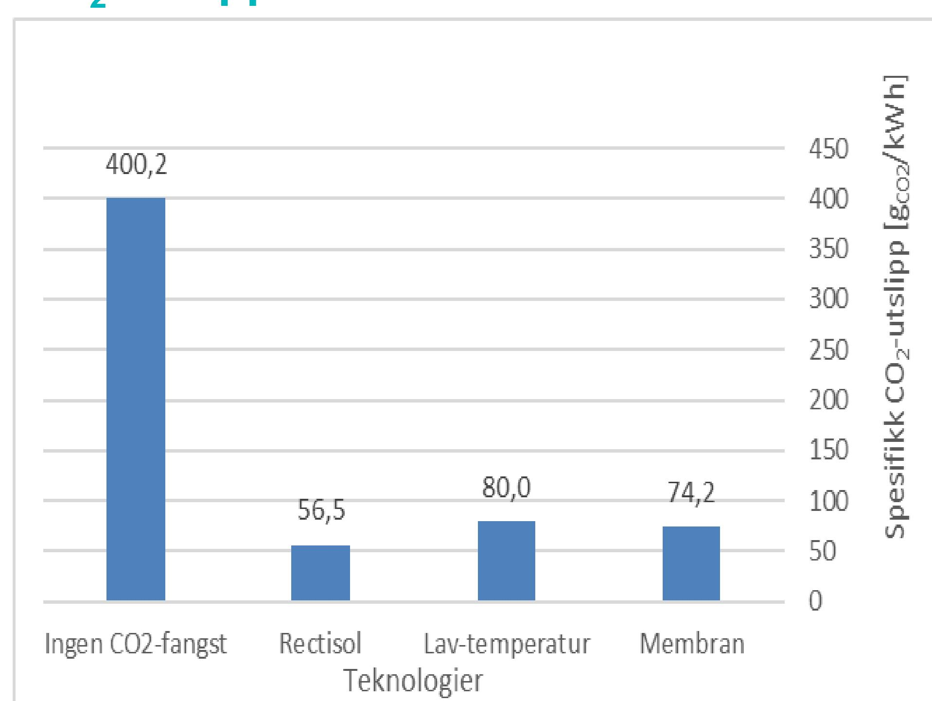
Det er beskrevet spesifikt CO<sub>2</sub>-utsipp, som er en verdi på hvor mye CO<sub>2</sub> som slippes ut i atmosfæren per kWh. Rectisol er lavest med 56,5 gCO<sub>2</sub>/kWh. Det er også vurdert hvor mye utsipp dette utgjør om dagen og i året:
