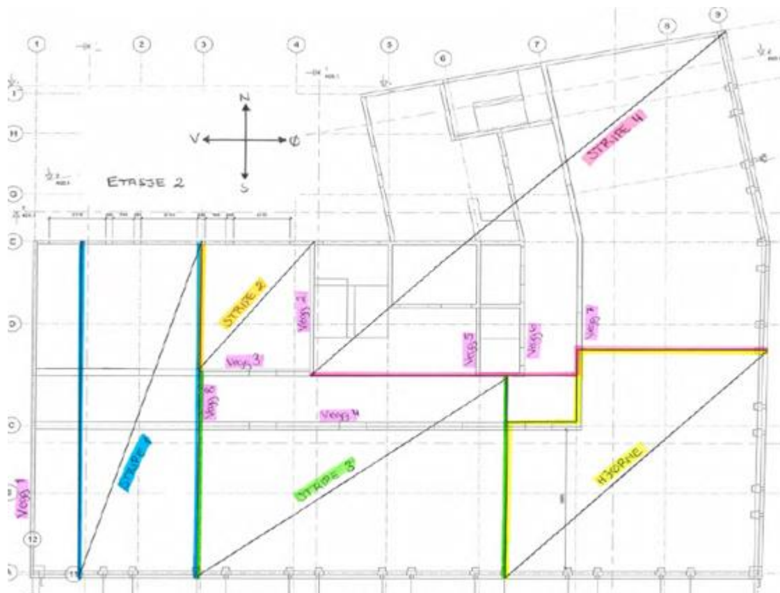
Figur 10: Viser inndeling av striper og vegger i etasje 2 –7
