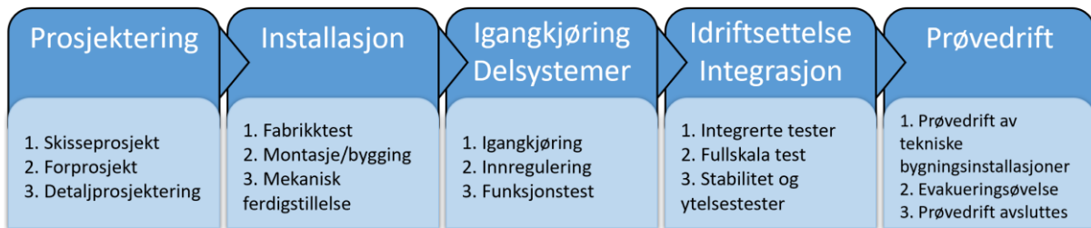
Figur 7: Faser i byggeprosesser, basert fra (Standard Norge, 2016, s. 3935) og (Standard Norge, 2019, s. 3)
