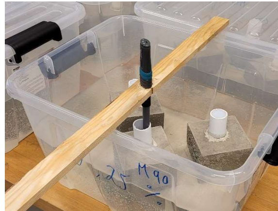
Figur 7 Måling med klorid-sensor
