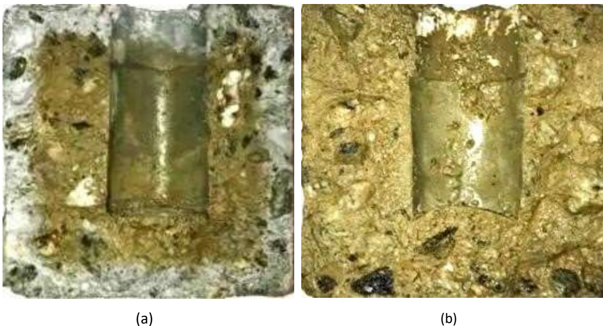
Figur 9 Sølvnitratspraytest eksempel: a) M60-3,5%-nr.1 høyre halvdel; b) M60-0%-nr.1 høyre halvdel
