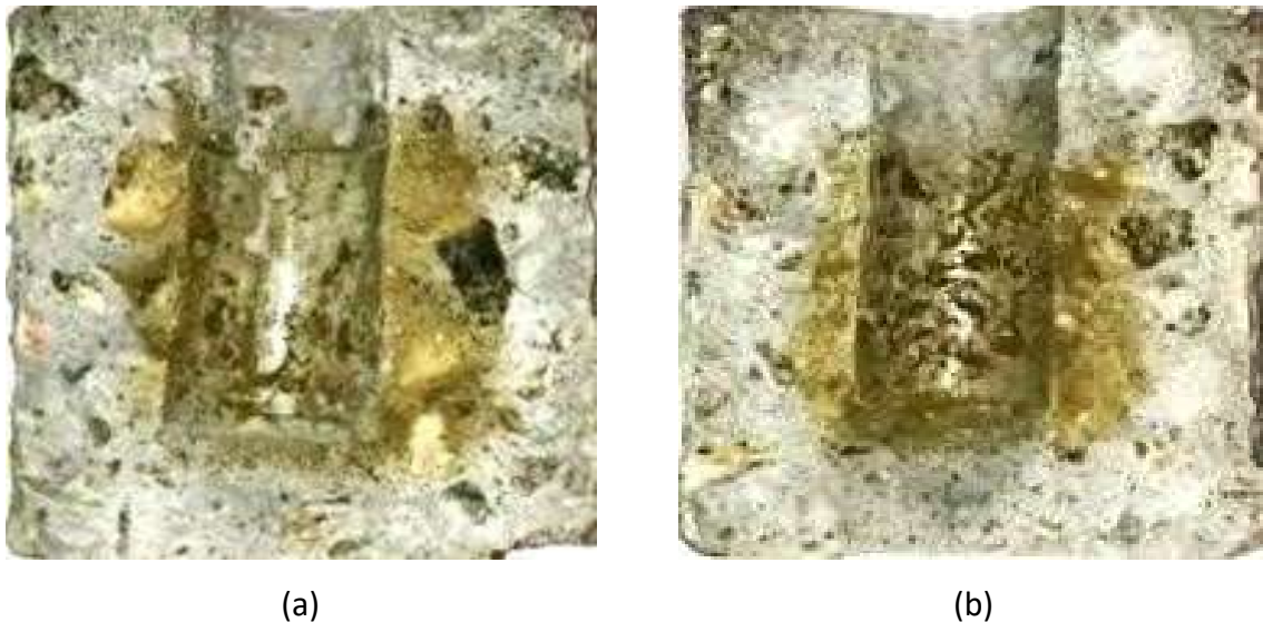
Figur 28 Sølvnitratpraytest M90-5,25%: a) nr.1 venstre halvdel; b) nr.2 høyre halvdel
