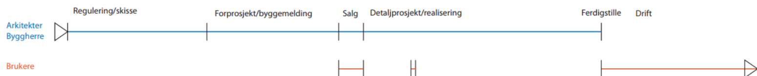
Figur 49. Prosessdiagram for kva arkitekt og byggherre samt brukar er med i prosessen frå oppstart til bustaden er tatt i bruk (A. S. Moe & Liaset, 2018).
