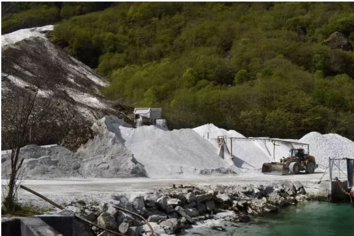
Figur 9 Anortositt som er lagret utildekket på fraktskipkaien ved Gudvangen (Photo: Halfdan Carstens; Carstens, 2020).
