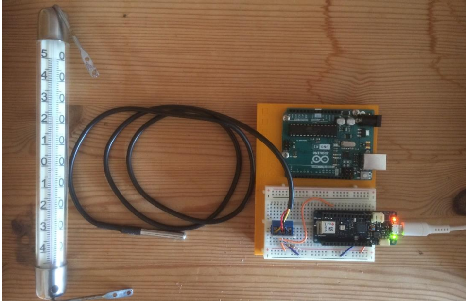
Bilde 10.4.2.1 Testmiljø arduinomåler vs. kvikksølvtermometer
