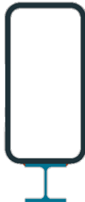
Figur 3.3 Rektangulær hulprofil med påsveist H-bjelke
