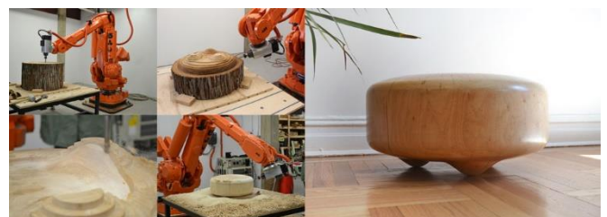
Figur 34: Viser en robotfres frese ut en puff
