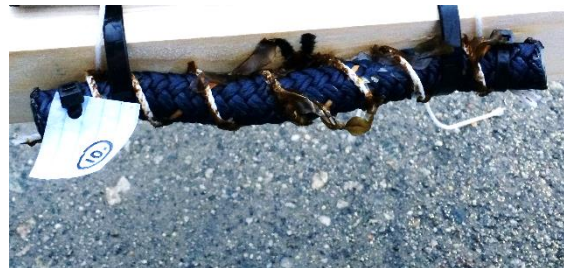
Figur 10: Tareprøven ferdig montert på rigg.
