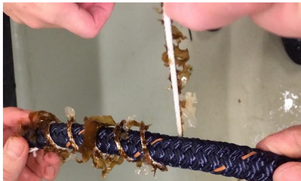
Figur 9: Rulling av tareline på taustump
