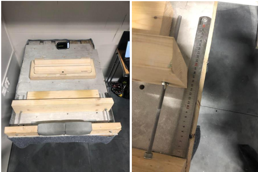
Figur 2: a) Testbordet sett ovenfra. b) Justerbar bakplate med fastmontert linjal for presis justering.
